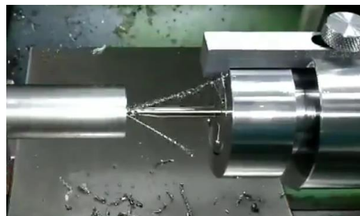
圖 (30)：螺絲攻正常切削排屑
