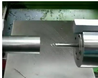
圖 (36)：螺絲攻斷裂
