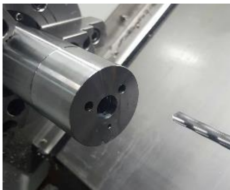
圖 (11)：等分圓孔鑽削加工
