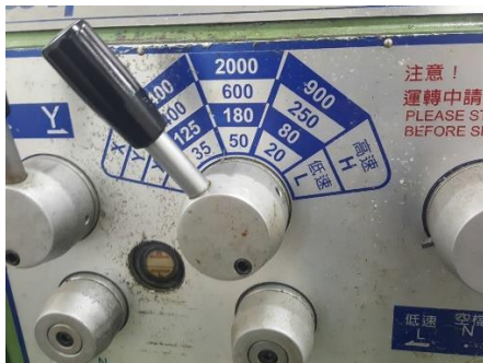
圖 (35)：車床轉速調整
