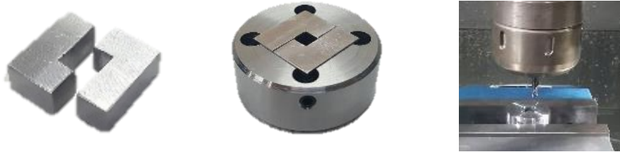
圖 (22): L 型鐵塊 圖 (23): 螺絲攻內孔組 圖 (24): 扭力扳手方孔銑削
